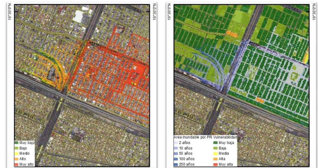
Ilustración 41 Peligros y vulnerabilidad a inundaciones, en las colonias Nuevo Valle de Aragón, Valle de Aragón 3ra Secc, Valle de Aragón 2da Secc.
