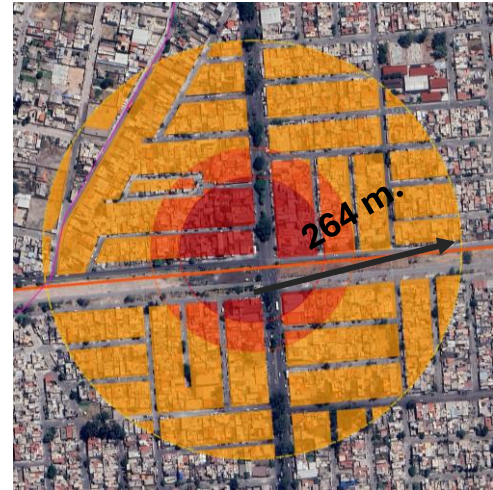
IMAGEN: RADIOS DE SOBREPRESIONES ALCANZADAS POR EXPLOSIÓN POR DETONACIÓN, EN ROJO LA ZONA DE MAYORES PRESIONES, NARANJA PRESIONES INTERMEDIAS (3.5 P.S.I.), DUCTO O POLIDUCTO DE COMBUSTIBLE SUBTERRÁNEO TRAZADO CON LÍNEA CONTINUA NARANJA.
