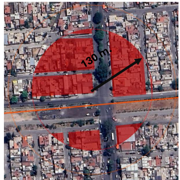
IMAGEN: ZONA CRÍTICA DE LA EXPLOSIÓN POR DETONACIÓN EN UNA ESTACIÓN DE CARBURACIÓN.
