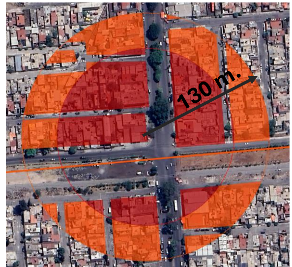
IMAGEN: RADIOS DE SOBREPRESIONES ALCANZADAS POR EXPLOSIÓN POR DETONACIÓN, EN ROJO LA ZONA DE MAYORES PRESIONES, NARANJA PRESIONES INTERMEDIAS (3.5 P.S.I.), DUCTO O POLIDUCTO DE COMBUSTIBLE SUBTERRÁNEO TRAZADO CON LÍNEA CONTINUA NARANJA.
