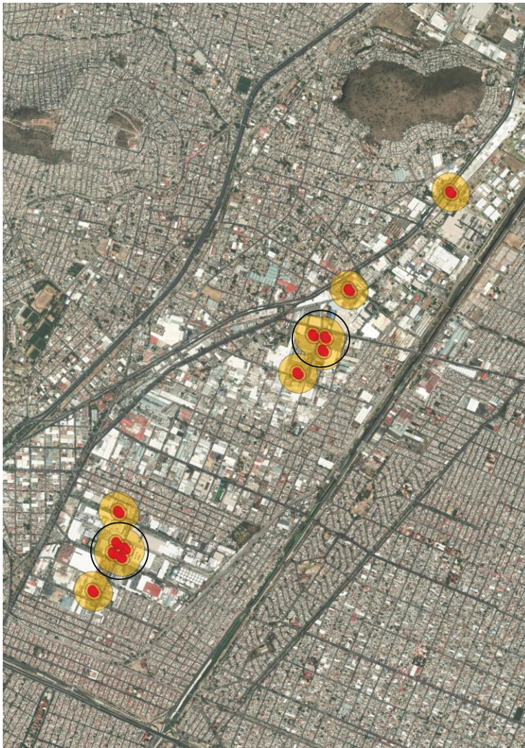
IMAGEN: ZONAS SOBREPRESIONES ALCANZADAS ANTE LA DETONACIÓN DE UN TANQUE DE ALMACENAMIENTO EN LAS DIFERENTES GASERAS EN EL TERRITORIO, ZONAS DE MAYOR RIESGO DEFINIDAS EN CIRCUNFERENCIAS COLOR NEGRO.
